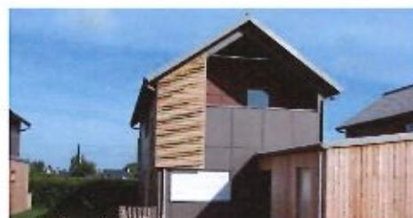
Exemple de dispositif de protection solaire (débord de toit)
