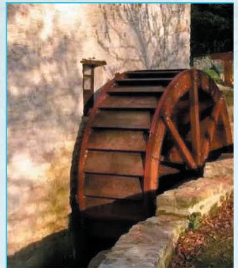
Roue à auget : l'eau arrive par le dessus, et son poids entraîne la roue
